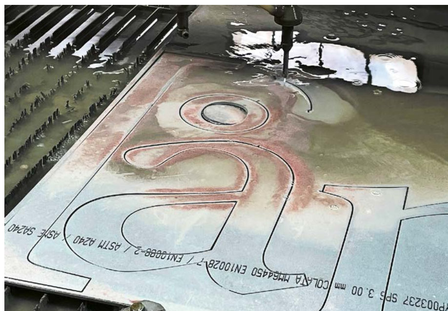
Die phonetischen Zeichen werden mit einer Wasserstrahlmaschine mit mehreren Tausend Bar Druck in Kombination mit Granatsand aus einer Chromstahlplatte herausgeschnitten.
